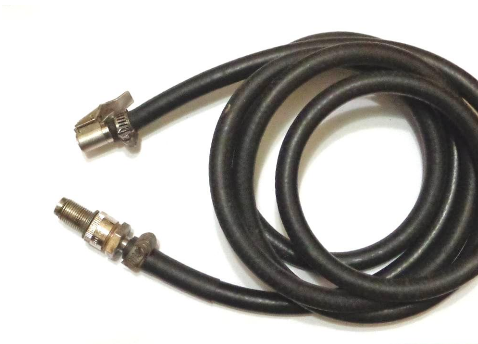
Рис. 2 Соединение штуцер со шлангом и наконечником
