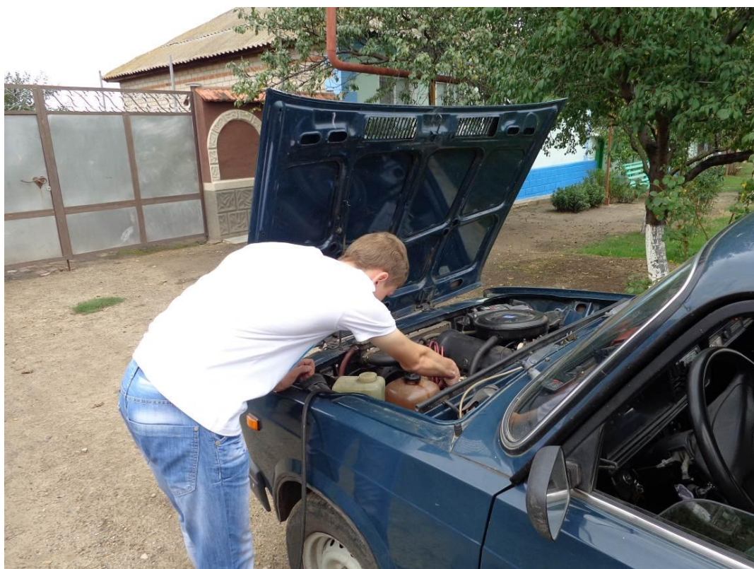
Рис. 3 Выворачиваем свечу из одного цилиндра двигателя
